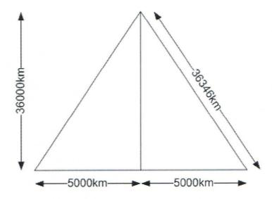
Abstand Sender/Empfänger zu Satellit  $\rightarrow \sqrt{[(5000 \text{km})^2 + (36000 \text{km})^2]} \approx 36346 \text{km}$ Satellit  $\rightarrow$  RTT = 4 x (36346564m) / 300.000.000m/s)  $\approx$  0,48462 = 484,62ms
