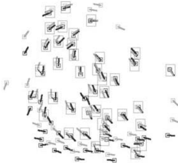
Abbildung 7: Minuzien, die gegen ein Template geprüft werden [Wayman05]
